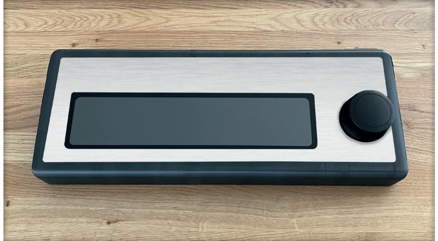
Die **GG PTZ Control** ist eine Steuerung für PTZ-Netzwerkcameras der Marke AXIS Communications via Touchpanel und Control Stick. Über den Control Stick können Schwenk-Neige- und Zoom-Funktionen der Kameras ausgeführt werden. Über das Touchpanel können die gewünschten Kameras ausgewählt und weitere Kamerafunktionen aufgerufen werden. Es können bis zu 24 Kameras hinterlegt werden.
